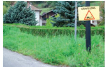
Les services techniques de la ville d'Alleverd ont, au cours de l'été, entretenu les voies communales. Sur certaines routes, du bitume a été répandu et recouvert de petit gravier. Cette opération permet de rendre étanche le revêtement de voirie afin de limiter les désordres dus au gel et au dégel. Le danger provisoire de ce travail est signalé par panneaux.
